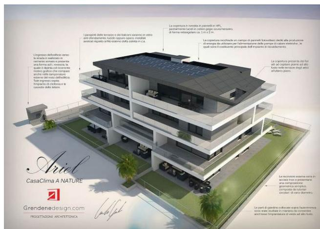
Dal punto di vista strutturale la parte fuori terra grava completamente in falso su un solettone in cemento armato rinforzato con un graticcio di travoni sottosporgenti.
